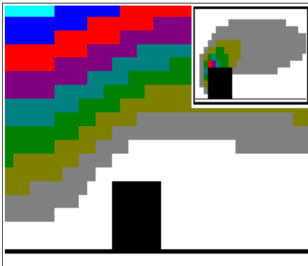
Рис. 37. Решение (63) на сетке 40 \times 20 узлов методом Гаусса-Зейделя
