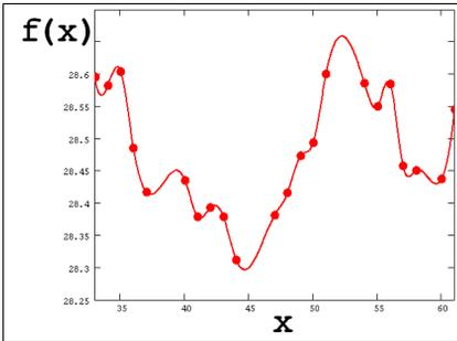
Рис. 28 Сплайн-интерполяция
